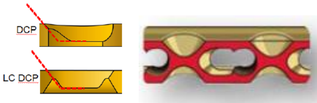
Fig.8.1.14 Ndërtimi i ndryshëm i folesë së vidës në DCP dhe LC DCP. (23)
