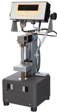
Figura 2.1 Ultratester – paisja që u realizuan matjet e forcës në shkëputje të bondimit
