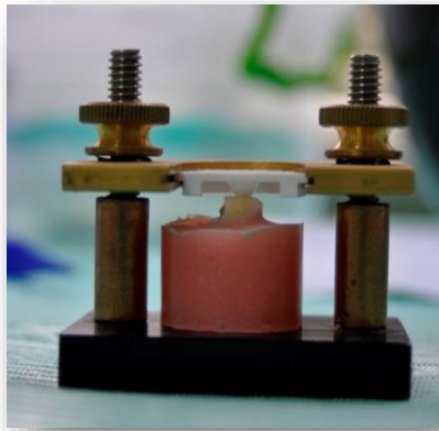
Figura 2.10 Përcaktimi i pjesës së sheshtë sipërfaqësore, me përmasat e përshtatshme për Ultratesterin.
