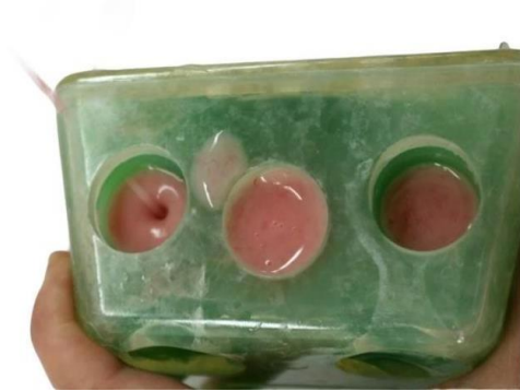
Figura 3.5-11 Derdhja e rezinës në brendësi të muflës
