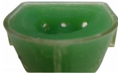
Figura 3.5-5 Krijimi i kanaleve të derdhjes dhe nxjerrja e modelit
