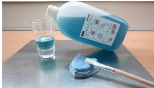
Figura 3.5-8 Izolimi i modelit të allçisë
